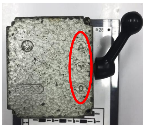
ภาพที่ 1.15 ลักษณะรูปร่างของสวิตช์โยกใช้เริ่มเดินมอเตอร์ไฟฟ้าแบบสตาร์-เดลตา
